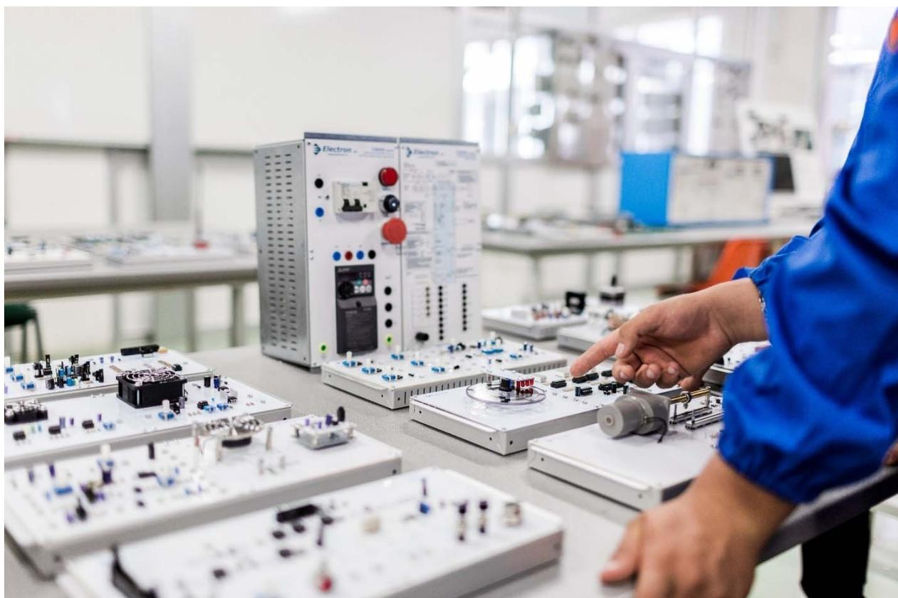
Este laboratorio incluye varios módulos para experimentar circuitos y principios comúnmente recurrentes en el campo de la electrónica de potencia, transductores y controles.
