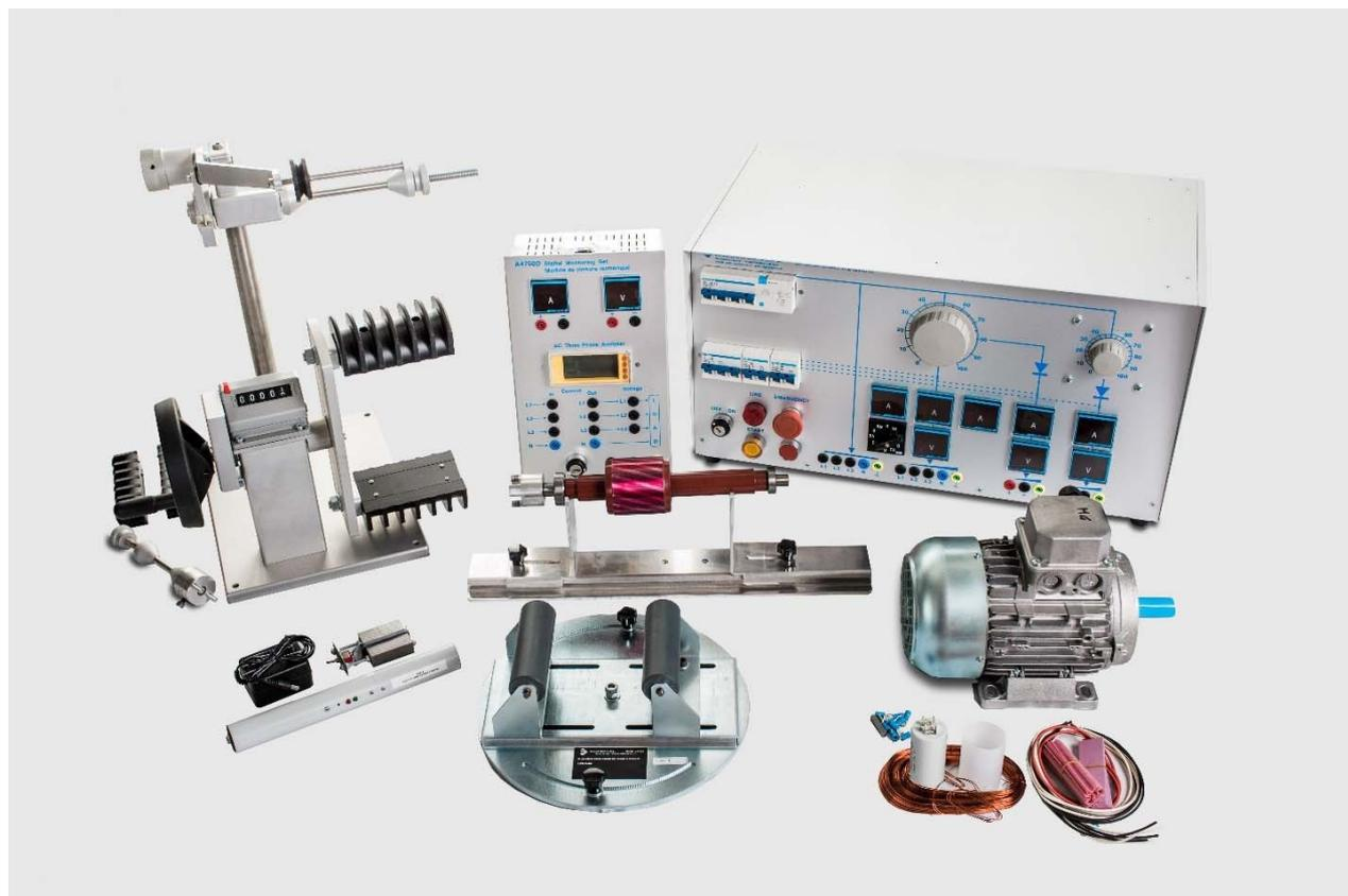
El laboratorio incluye kits y accesorios para construir, reparar y probar motores trifásicos de CA y transformadores. Son adecuados para ser utilizados en cursos básicos de electricidad, así como en cursos de formación profesional para técnicos de mantenimiento y reparación.
